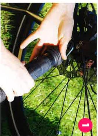
1. Trenne Fahrrad und Anhänger durch das Öffnen der Weberkupplung. Drücke den silbernen Knopf und ziehe mit einer Drehbewegung die Deichsel von der am Fahrrad befestigten Kupplung.
